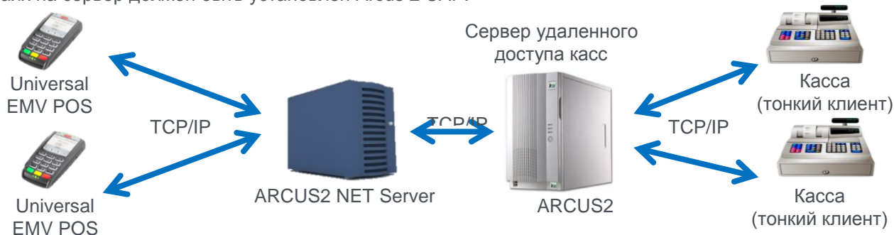
Рис. 10. Схема работы ARCUS NET Server v.1.3
