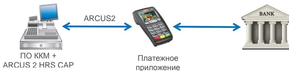
Рис. 7. Схема работы ARCUS 2 HRS CAP
